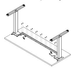
**3.** FASTEN THE CONTROL BOX AND HANDSWITCH TO THE TABLE TOP
