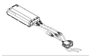
6. CONNECT THE SUPPLIED POWER CORD (AC) TO THE CONTROL BOX
