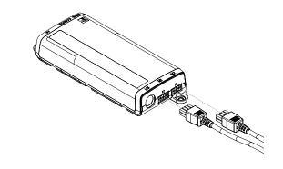
5. CONNECT THE HANDSWITCH (HS) CABLE TO THE CONTROL BOX
